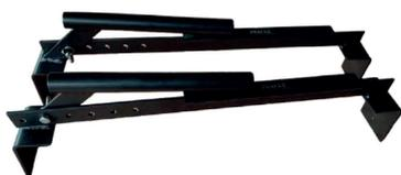
O acessório criado para facilitar a locomoção de tijolos e blocos na construção civil. Com capacidade para até 25kg ele é produzido em aço AISI 1020 na cor preta. A ferramenta que vai facilitar o dia a dia na sua construção.
